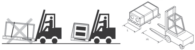
Рис. 1В Подъем и перемещение вентустановок
