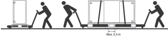
Рис. 1Б Подъем и перемещение вентустановок
