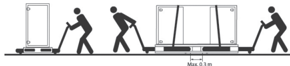
Рис. 1Б Подъем и перемещение вентустановок
