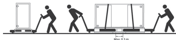
Рис. 1Б Подъем и перемещение вентустановок
