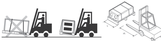
Рис. 1В Подъем и перемещение вентустановок
