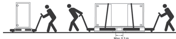
Рис. 1Б Подъем и перемещение вентустановок
