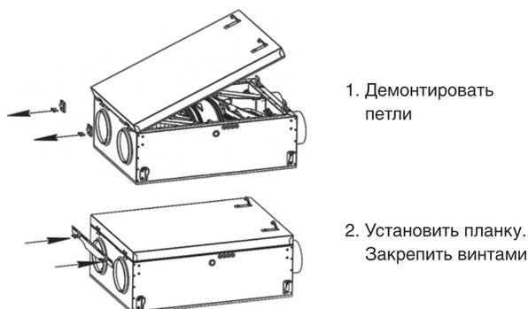
Рис. 4 Съемные петли Alpha 400 Compact, Alpha 550 Compact
