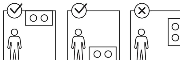
Рис. 2 Способы монтажа Alpha 400 Compact и Alpha 550 Compact
