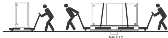
Рис. 1Б Подъем и перемещение вентустановок
