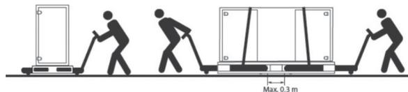
Рис. 1Б Подъем и перемещение вентустановок
