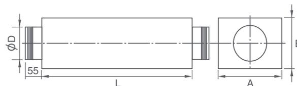
Шумоглушители прямоугольные Provent KS устанавливаются в системах вентиляции для уменьшения аэродинамических шумов. Корпус шумоглушителей изготовлен из оцинкованной стали, в качестве звукопоглощающего материала используется минеральное волокно.
