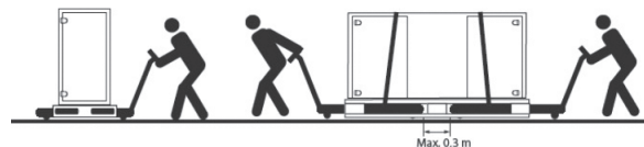
Рис. 1Б Подъем и перемещение вентустановок
