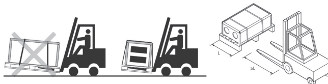
Рис. 1В Подъем и перемещение вентустановок
